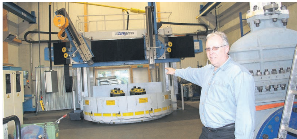
Niederlassungsleiter Thomas Schmeelk zeigt die Karussell-Drehmaschine, auf der Bauteile mit einem Gewicht bis zu 16 Tonnen bearbeitet werden können
