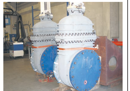
In der Werkstatt von Bardenhagen komplett überholt: ein 30 Zoll Chlorgasschieber
